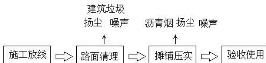
图3.8-8 道路维修改造施工工艺流程图
