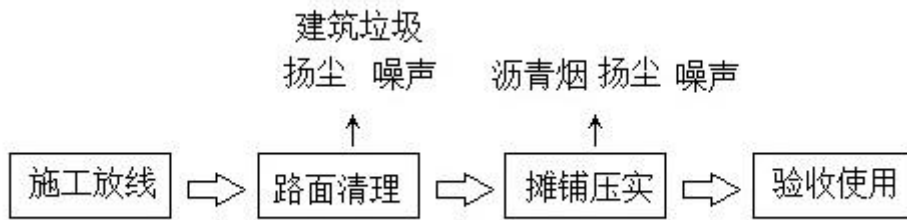
图3.12-7 道路维修改造施工工艺流程图
