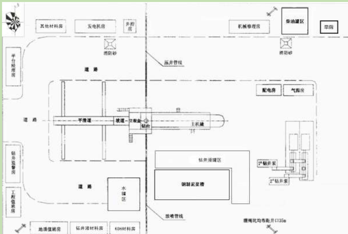
图 3.6-1 井场施工平面布置图
