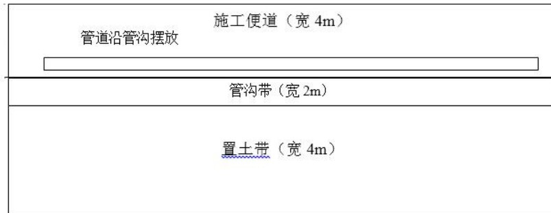
图3.1-5 管道开挖施工平面布置示意图
