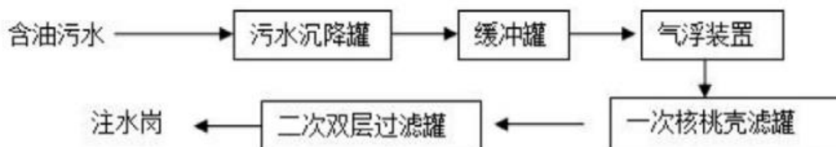
图3.3-1 新肇联合油污水处理站工艺流程图
