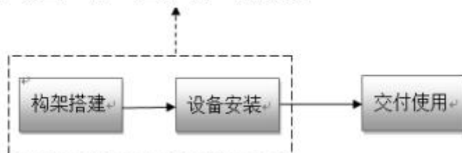
图 5-1 变电站扩建施工期工艺流程图
