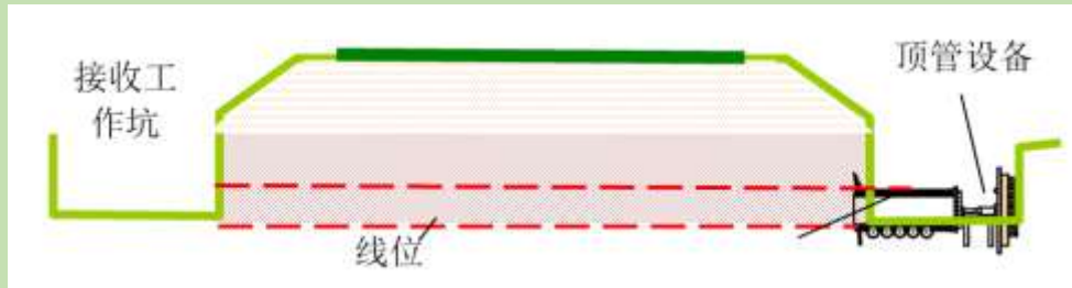
图 3.7-4 顶管施工示意图
