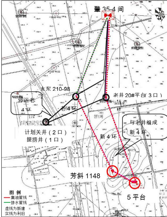
图 3.4-5 5#平台及芳斜 1148 井集油管线
