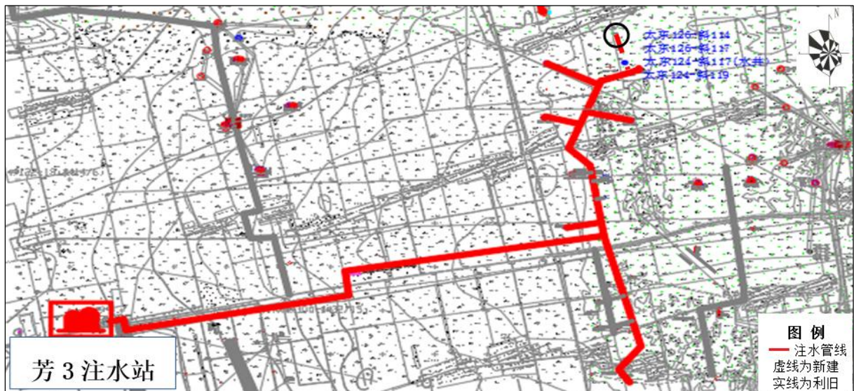
图 3.4-8 2#平台注水管线
