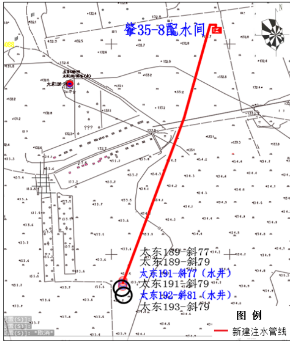
图 3.4-9 4#平台注水管线
