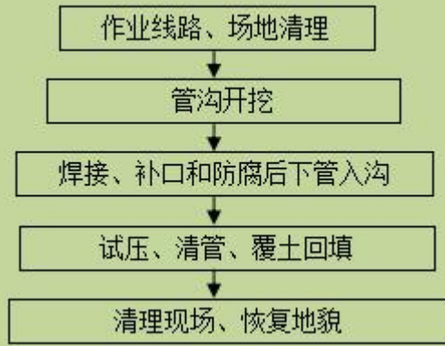
图3.1-1 管道施工建设过程
