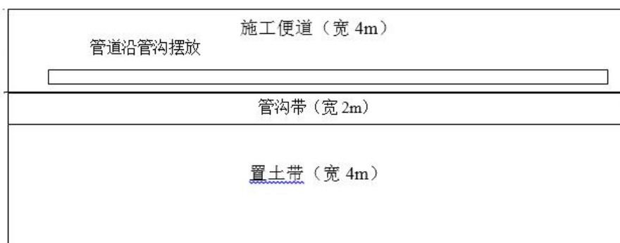
图 3.8-2 管道施工作业断面图
