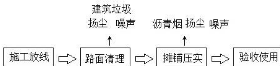
图3.6-6 井排路改造施工工艺流程图
