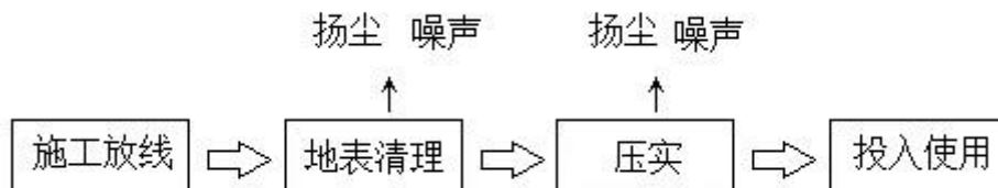
图 3-14 道路施工工艺及产污节点图
