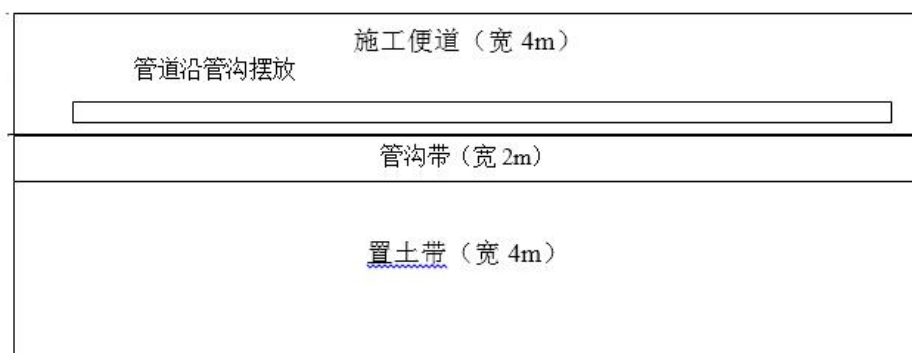
图3.7-3 管道开挖施工平面布置示意图
