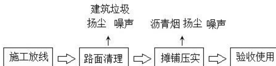
图3.6-7 道路维修改造施工工艺流程图
