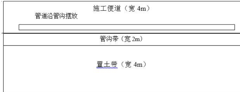
图3.1-4 管道开挖施工平面布置示意图
