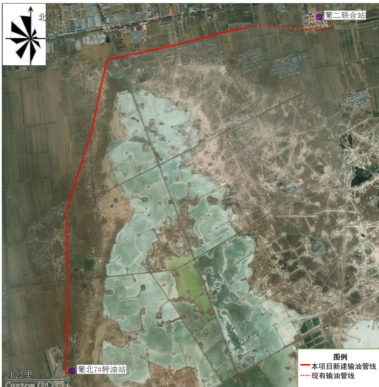
葡北7#转油站与葡二联合站输油管线走向示意图
