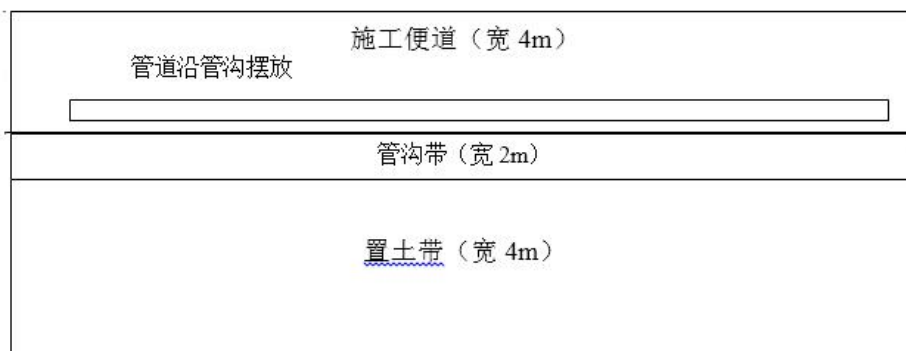
图 3.6-3 管道开挖施工平面布置示意图
