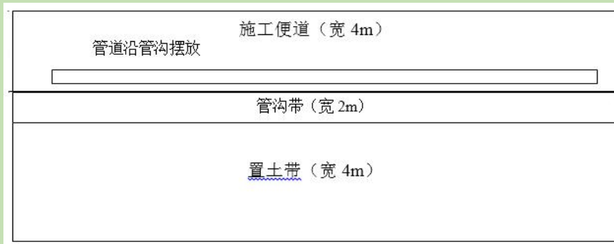
图 3.7-3 管道开挖施工平面布置示意图
