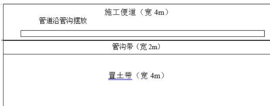
图3.7-3 管道开挖施工平面布置示意图
