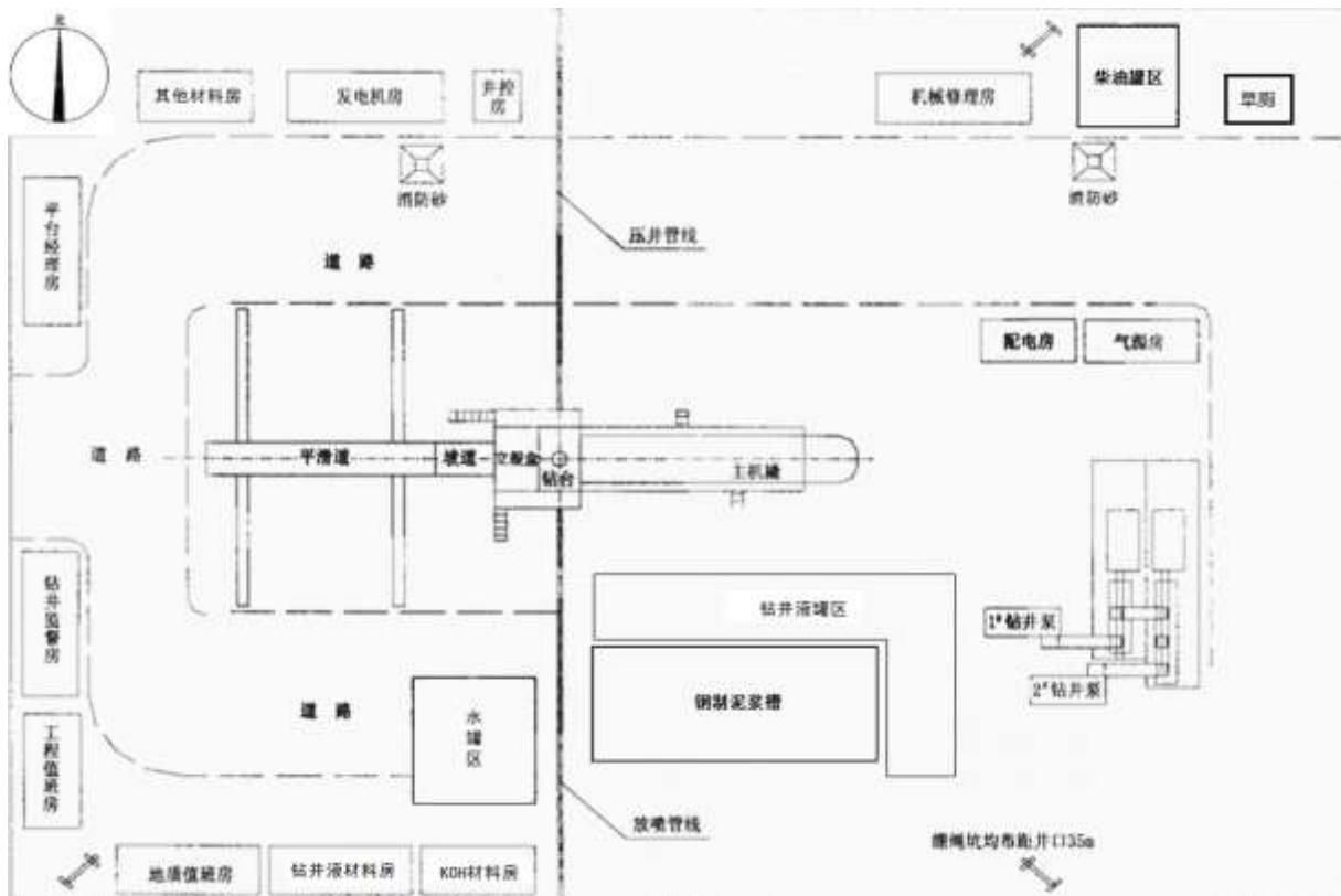
图 3.7-1 井场施工平面布置图
