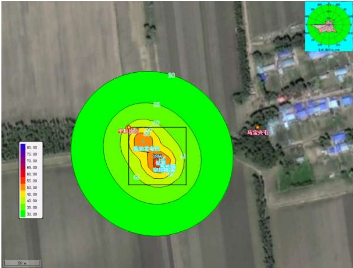
图 5.3-1 施工井场噪声预测图
