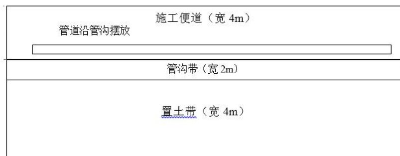
图3.1-5 管道开挖施工平面布置示意图
