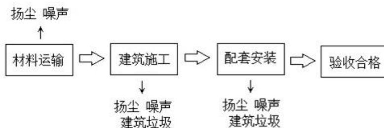
图 2-2 施工期工艺流程及产污节点图
