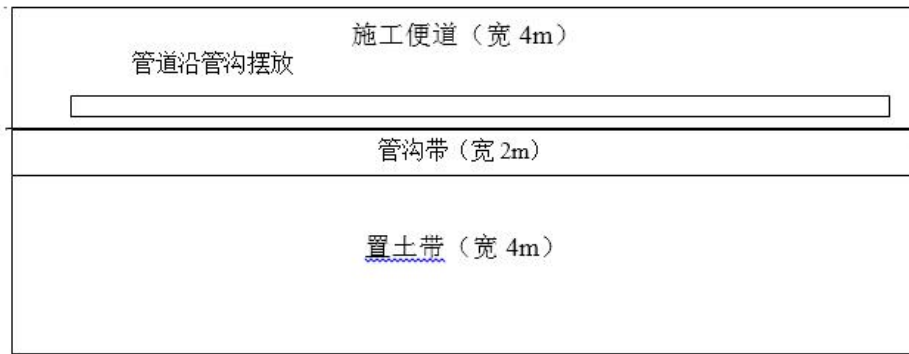
图3.4-5 管道开挖施工平面布置示意图
