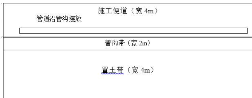
图 3.8-2 管道施工作业断面图
