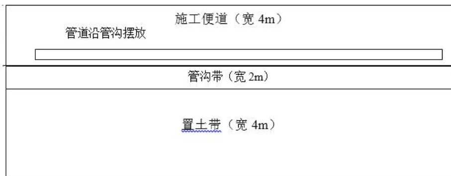
图3.7-3 管道开挖施工平面布置示意图
