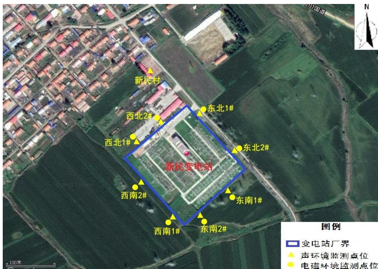
图 7-1 新民变电站厂界监测布点图
