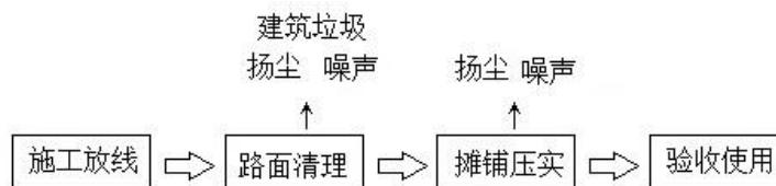
图3.6-6 道路改造施工流程图
