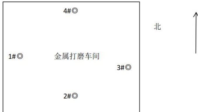
图 3-7 金属打磨车间颗粒物监测点位布设示意图
