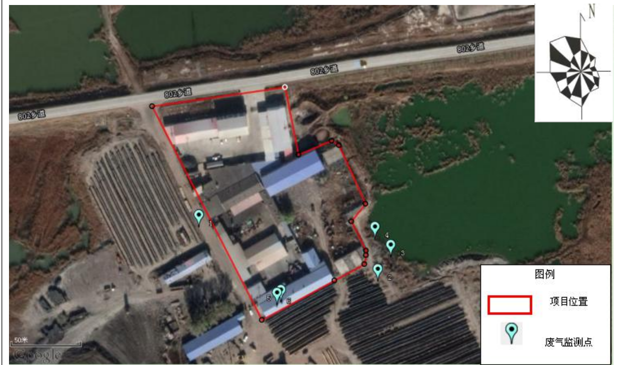
图 6-2 废气及非甲烷总烃监测点位布设示意图
