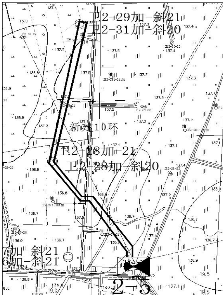
图 3.6-14 2-5#阀组间集油管网布局示意图
