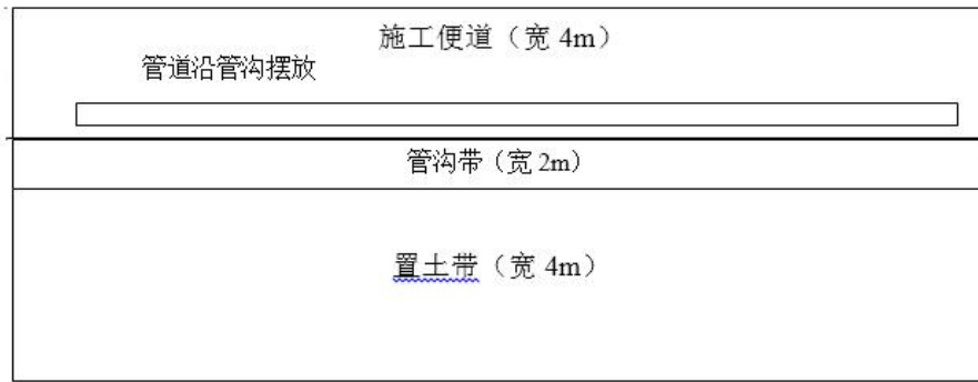
图 3.8-4 管道开挖施工平面布置示意图
