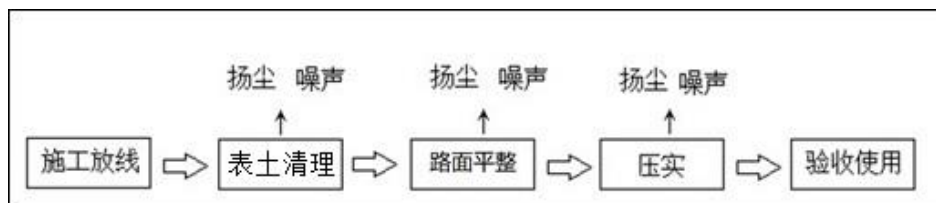
图 3.12-5 道路施工流程图。
