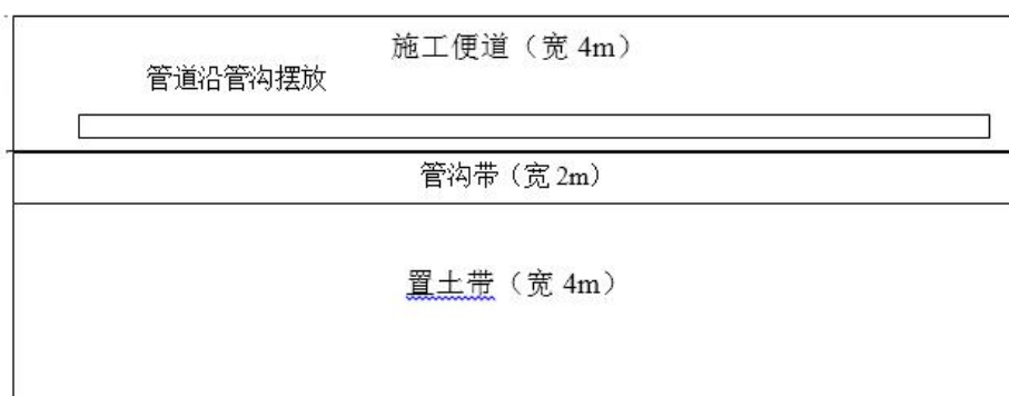
图3.7-3 管道开挖施工平面布置示意图
