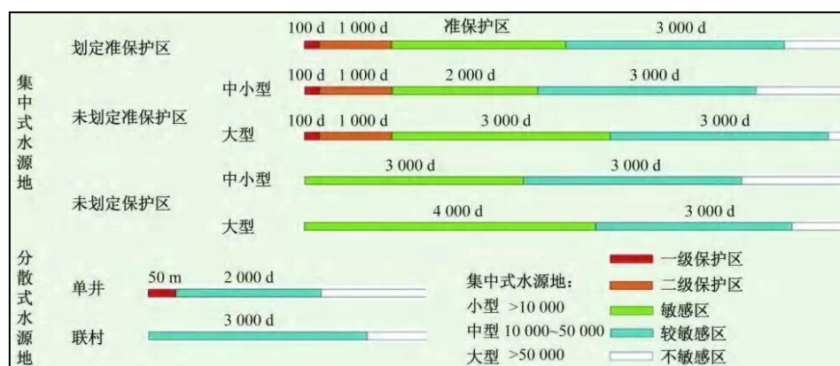
图 2-1 地下水敏感性判定依据
