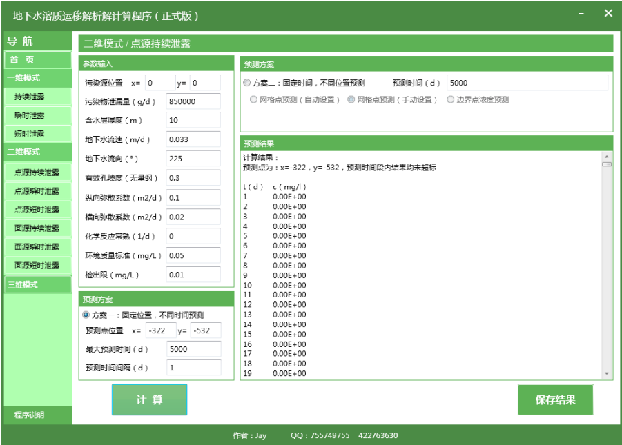
图 5.3-7 套管破损泄漏 5000d 内对李屯分散式饮用水井的影响结果图
