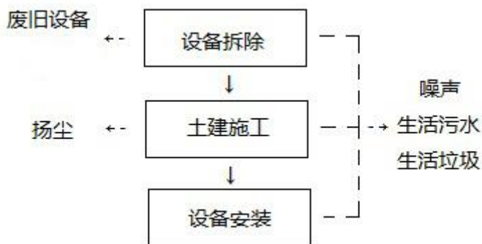
图 2-2 施工期工艺流程和产污节点图
