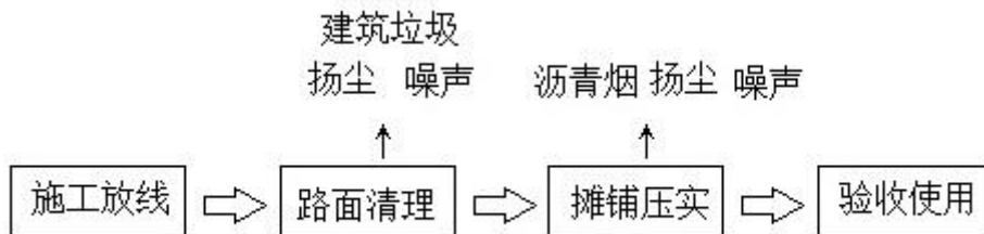
图3.8-8 道路维修改造施工工艺流程图
