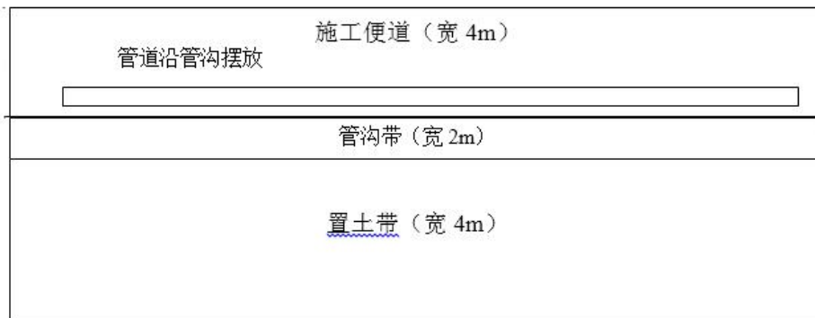
图 3.8-5 管道开挖施工平面布置示意图
