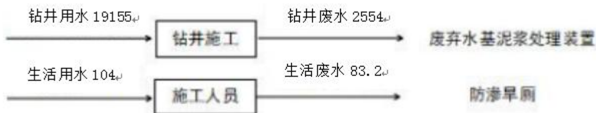
图 3-1-5 钻井时期水平衡图（单位： \text{m}^3/\text{施工期} ）
