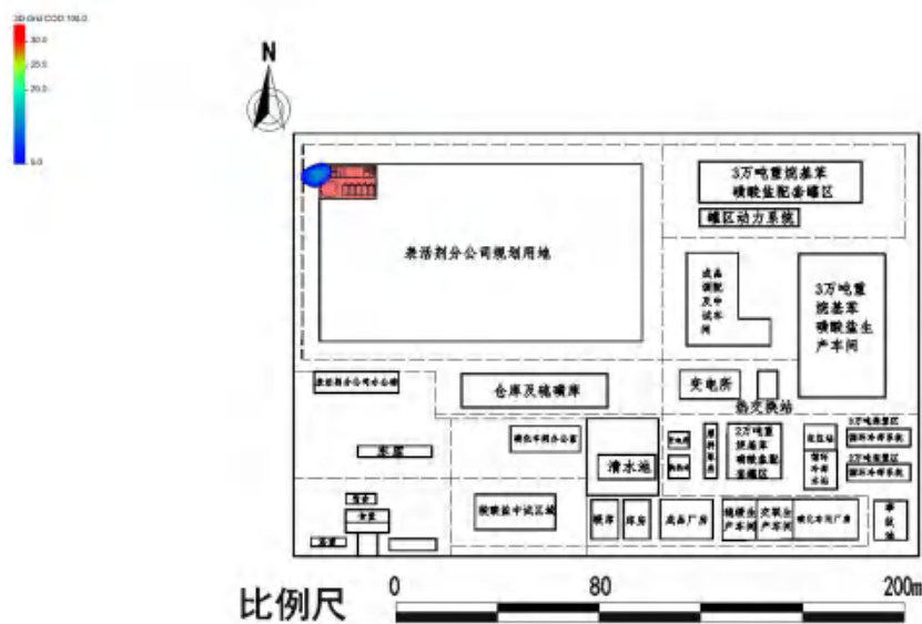
图 5-2-18 短时渗漏 100dCOD 污染晕的迁移扩散
