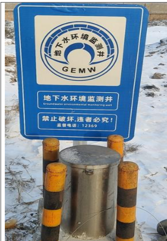
地下水监测井
