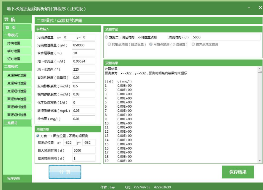
图 5.5-7 套管破损泄露 5000d 内对李屯分散式饮用水井的影响结果图
