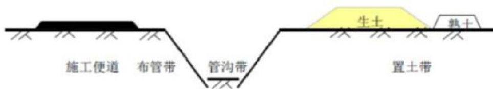
图 3-1-2 管道施工平面布置图
