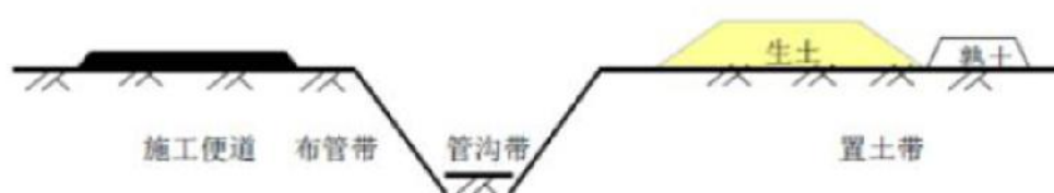
图3-2-2 管道施工平面布置图
