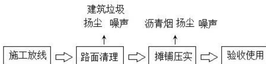
图3.4-9 道路施工流程图
