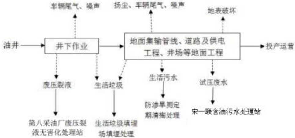
图 4-8 管线施工建设工艺流程及产物节点
