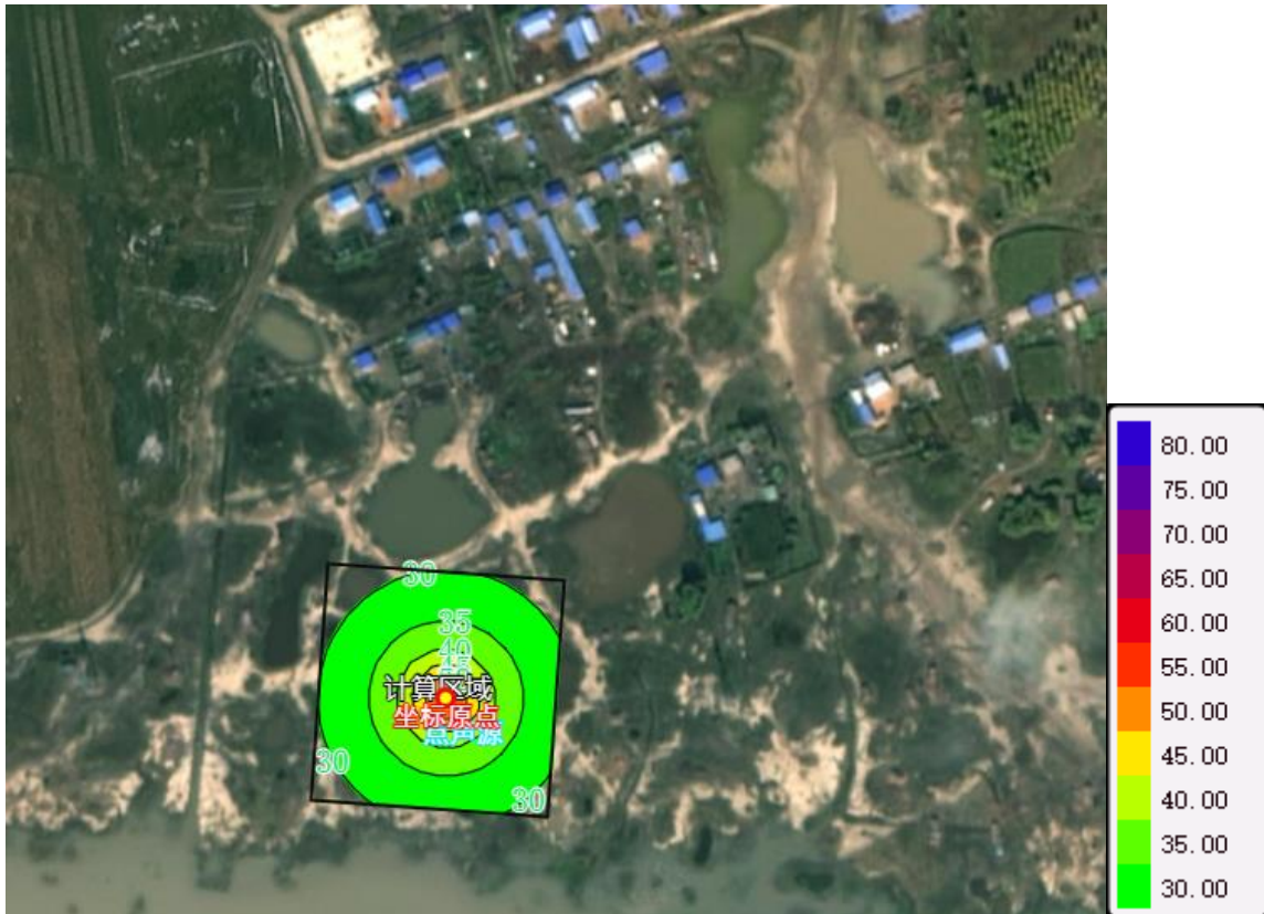
图 5.4-1 7#平台井场噪声及对周边 200m 范围内敏感点影响预测结果图
