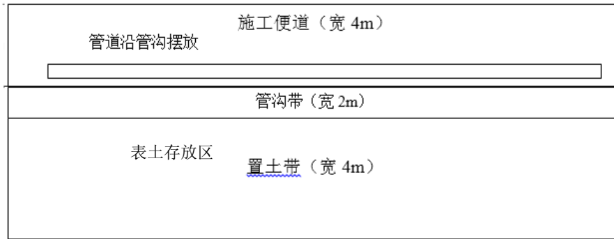
图 3.8-3 管道开挖施工平面布置示意图
