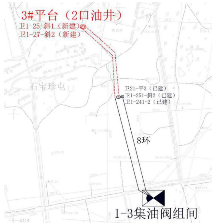
图 3.5-1 1-3#阀组间集油管网布局
