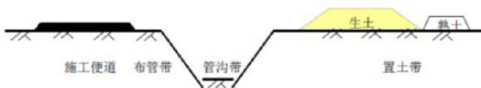
图3-2-2 管道施工平面布置图
