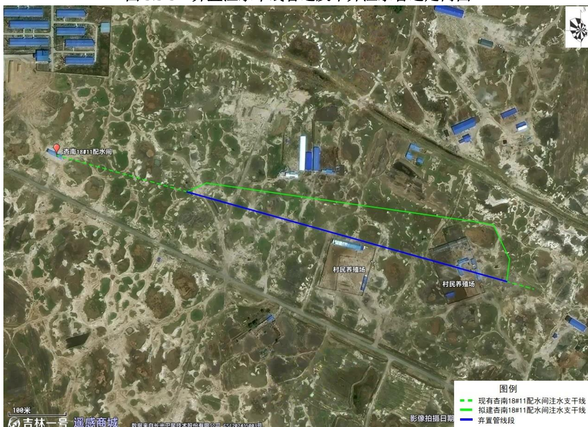
图 3.3-4 弃置注水支干线管道走向图
