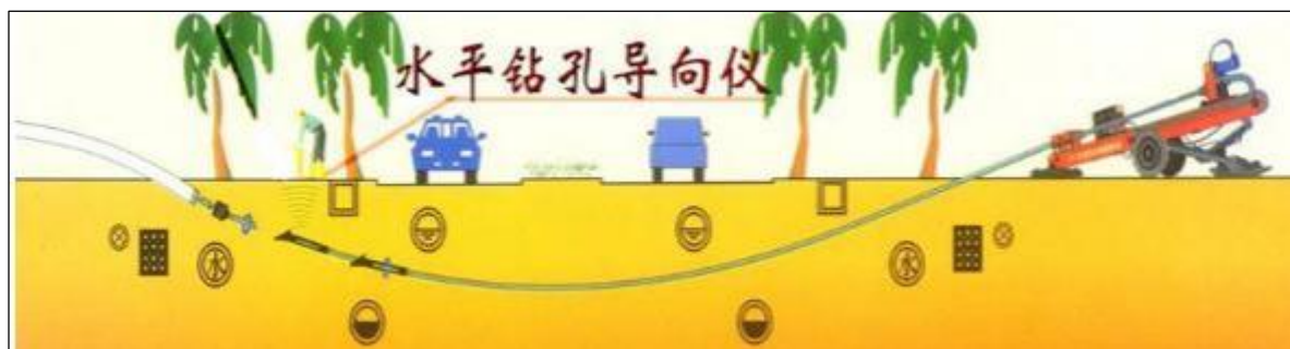
图 3.6-5 定向钻穿越施工示意图
