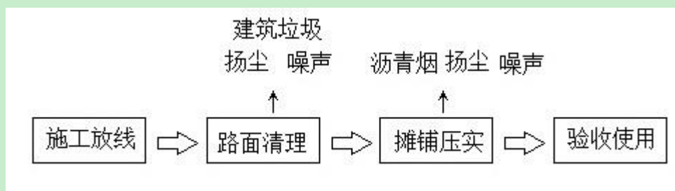
图3.6-6 井排路改造施工工艺流程图
