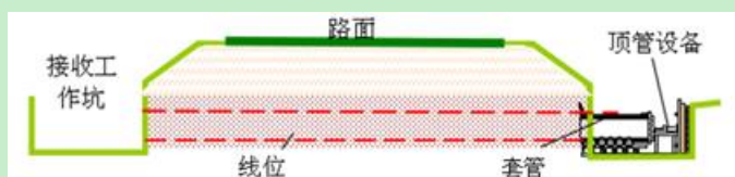
图 3.6-5 顶管施工示意图
