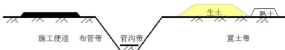
图 3-4-11 管道施工平面布置图
