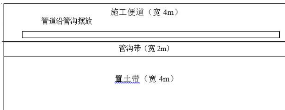
图 3.6-3 管道开挖施工平面布置示意图
