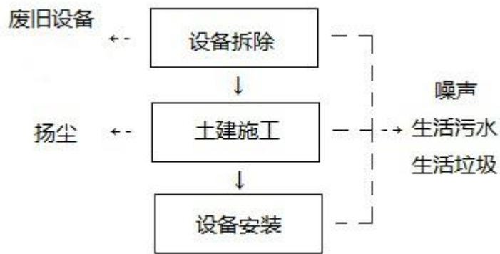
图 2-1 施工期工艺流程及产污节点图
