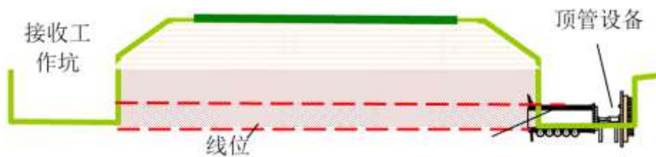
图 3.6-5 顶管施工示意图
