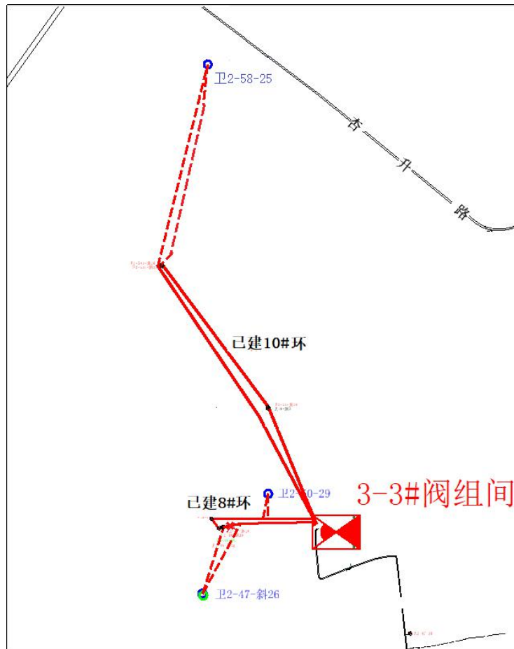
图 3.5-4 3-3#阀组间集油管网布局
