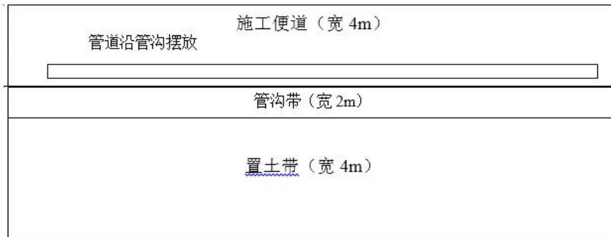
图 3.8-3 管道开挖施工平面布置示意图
