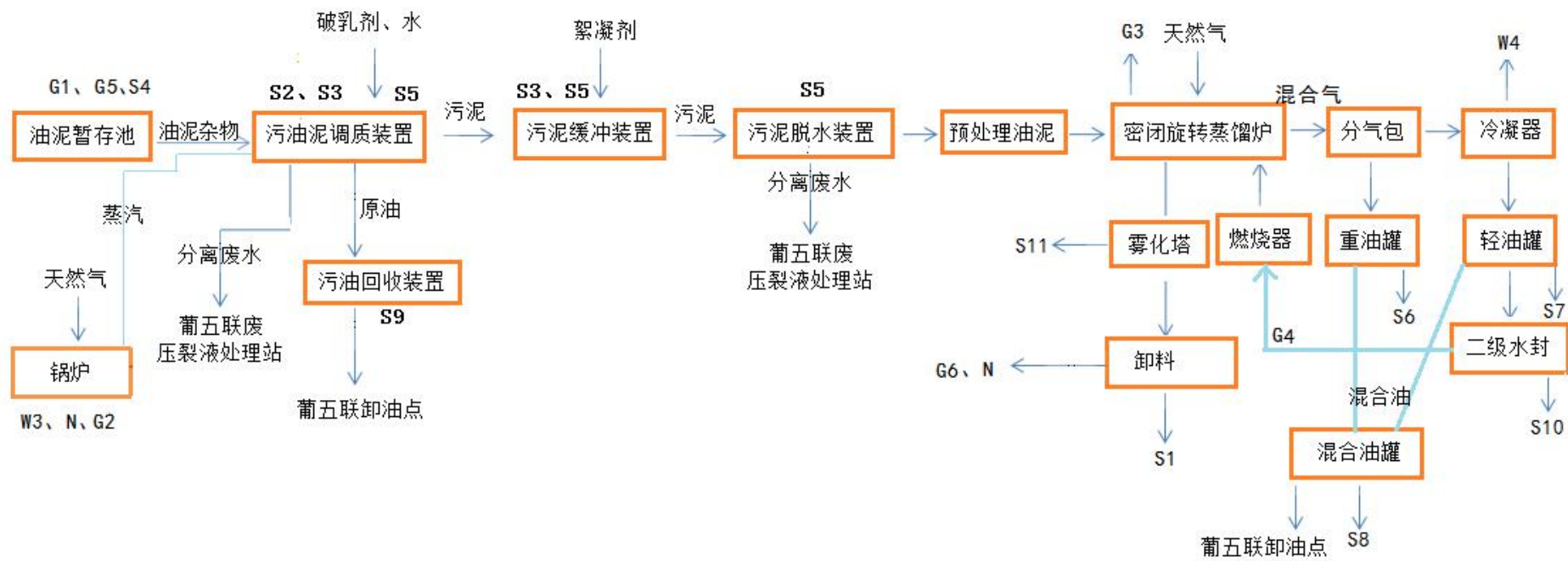
图 3.2-2 运营期工艺流程及产污节点示意图
