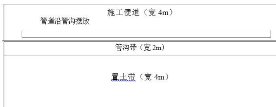
图 3.8-3 管道开挖施工平面布置示意图
